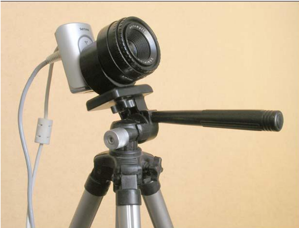
Webcam Philips ToUcam PRO II avec objectif Domiplan 2,8/50 fixée à l'aide d'un adaptateur nouvelle version. La poignée de la monture est placée vers l'avant, sinon il serait difficile d'observer des objets situés très au dessus de l'horizon.
